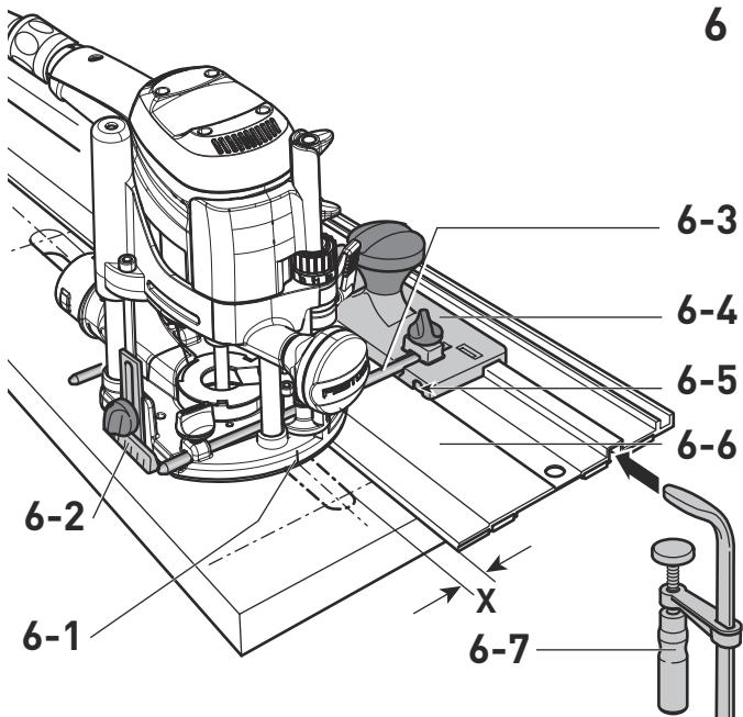
Pour pouvoir travail sur tracé, les repères sur la table de fraisage [6-1] et l'échelle graduée sur le support [6-2] indiquent l'axe médian de la fraise.
