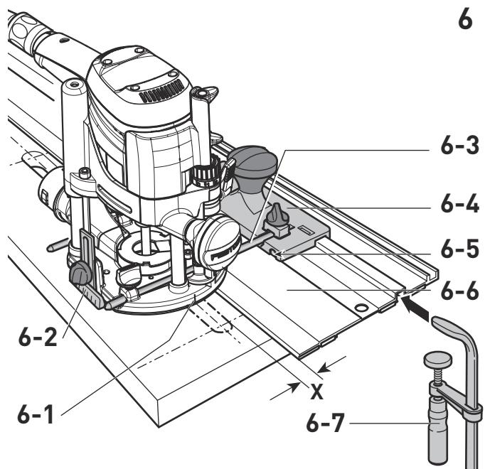
Para poder trabajar con una línea de corte, las marcas de la mesa de fresar [6-1] y la escala del apoyo [6-2] apuntan al eje central de la fresa.
