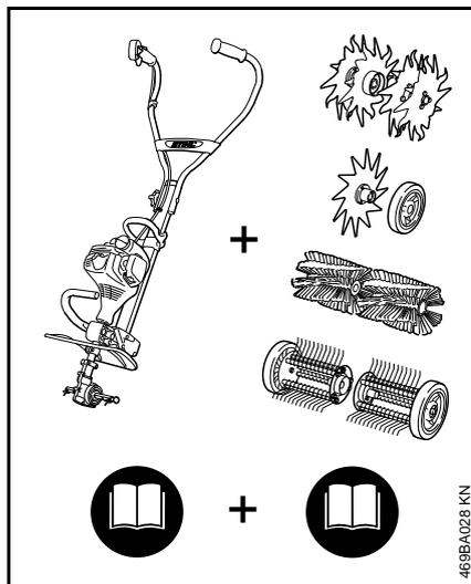
El sistema MultiSystem de STIHL, permite combinar diversos motores MultiEngine y accesorios MultiTool para formar una máquina. En el presente Manual de instrucciones, la unidad funcional compuesta por el motor MultiEngine y el accesorio MultiTool se denomina la máquina.
