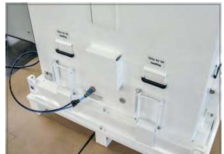
Vízgőzálló tartály túlnyomással végzett tömítésvizsgálattal
