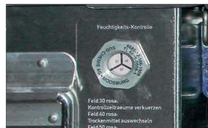
Automatikus nyomáskiegyenlítő szelep és nedvességkijelző az alapfelszerelésben.
