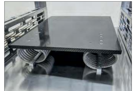
Platform, rezgéstűrő elhelyezés gumi pufferekkel vagy drótköteles tompítóval.
