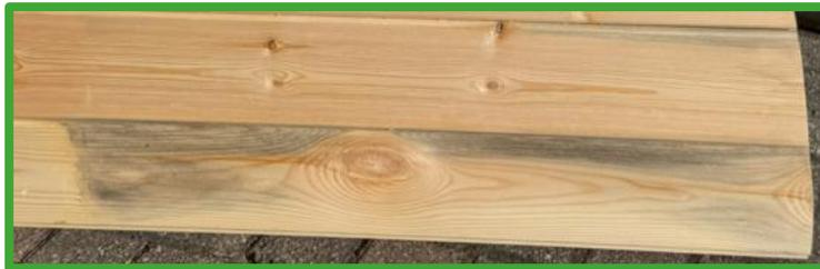
Solche oberflächlichen Verfärbungen können grundsätzlich bei unbehandeltem Holz auftreten, das temporär hoher Luftfeuchtigkeit oder direktem Wasserkontakt ausgesetzt war – zum Beispiel während Lagerung, Transport oder durch Witterungseinflüsse.
