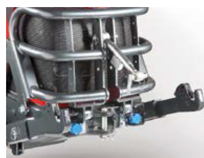
FRONT HEFINRICHTING In combinatie met de bullbar en 1 dubbelwerkend ventiel, voor gebruik van front werktuigen.
