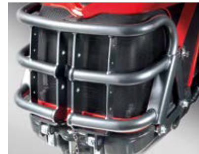
BULLBAR Stalen buis bescherming die de carrosserie beschermt; tevens het derde punt voor de hefinrichting.
