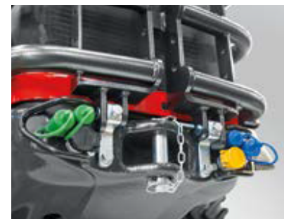
SNELKOPPELINGEN VOORZIJD Front montering > 6 aan de achterzijde gerepliceerde koppelingen, waarvan 2 dubbelwerkend + 1 elektronisch regelbare continue afgifte en 1 enkelwerkend.
