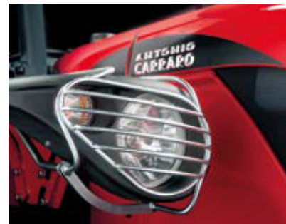
KOPLAMPBESCHERMERS Ze beschermen de lichtunits en zorgen er ook voor dat de carrosserie er aantrekkelijker uitziet.
