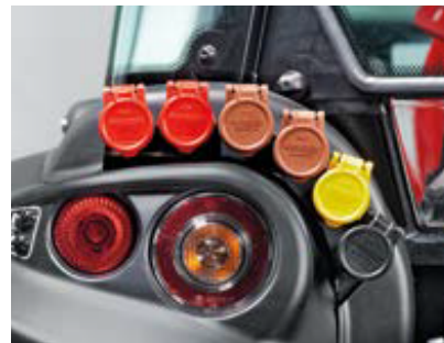
VLAKKE SNELKOPPELINGEN Gemakkelijk aankoppelen; geen olie lekkage en betere reiniging.
