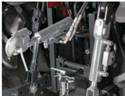
HYDRAULISCHE TOP- EN TREKSTANG Eenvoudige hydraulische verstelling van de top- en trekstang
