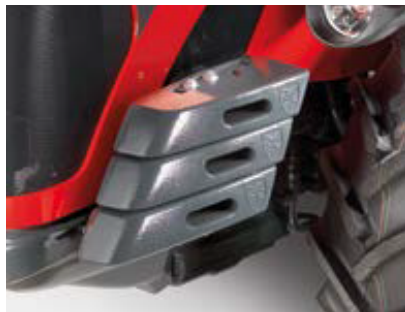
FRONT GEWICHTEN Perfect geïntegreerd in de carrosserie van de tractor; het verandert niets aan de wielbasis of de afmetingen van de tractor.
