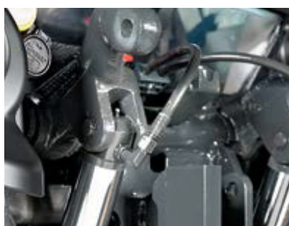
HYDRAULISCHE LAST ONDERSTEUNING UNIFLEX systeem voor hefinrichting achter
