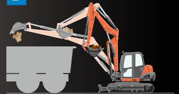
**C** Efficient vertical digging
