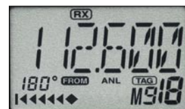
fönstret i CDI-läge
