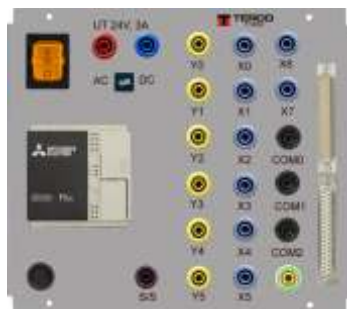
TF8050-FX3s PLC-modul Mitsubishi MelsecFX3s 6 ingångar, 8 utgångar Ström max för applikation: 24V, 3A
