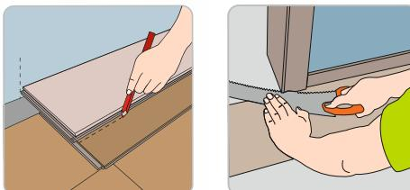
Tocul usii din lemn ar trebui sa fie scurtat suficient pentru a putea introduce o placa de laminat dedesubt. Fixati panoul, apoi glisati placa sub tocul usii. Pastrati un spatiu de expansiune sub cadrul usii de 8-10 mm.
