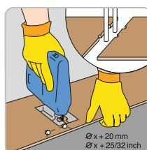
Daca aveti conducte de incalzire, masurati pozitia lor exacta si marcati-o pe laminat. Adaugati 20 mm dimensiunea conductei, deoarece laminatul trebuie sa se poata deplasa in toate directiile in jurul conductei.
