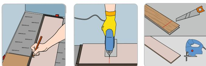
Daca folositi un fierastrau manual, taiati pe partea cu modelul, dacă utilizati un fierastrau electric, taiati intotdeauna pe partea din spate a placii. O lama de fierastrau bine ascutita este necesara pentru obtinerea celui mai bun rezultat
