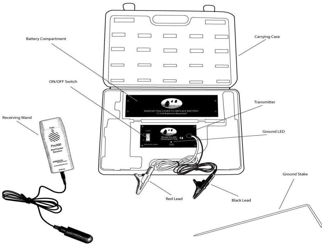
El localizador de cables Pro290 de Armada Technologies está diseñado para encontrar cables que se hayan roto o perdido, y para detectar sus trayectorias. El kit completo consiste de:
