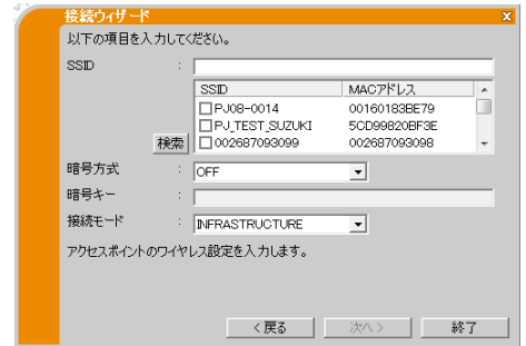
図 3.2.4.3: プロジェクターとアクセスポイントを無線で接続する
