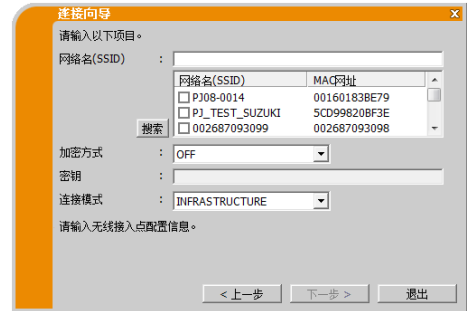
图 3.2.4.3: 投影机通过无线 LAN 与接入点连接
