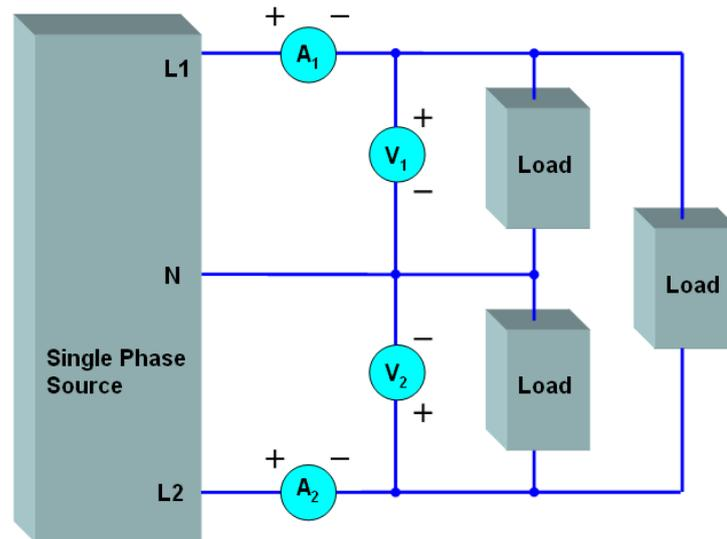
Figure 4-78 1P3W Wiring Diagram
