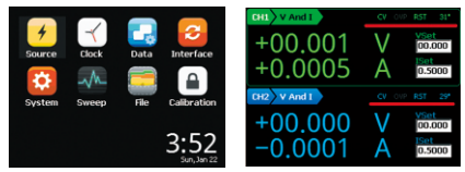
主選單操作界面 電壓/電流設定畫面及溫度顯示
