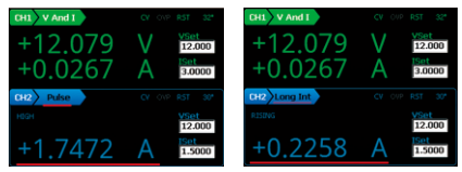
脈波電流量測畫面 Long Integration量測畫面
