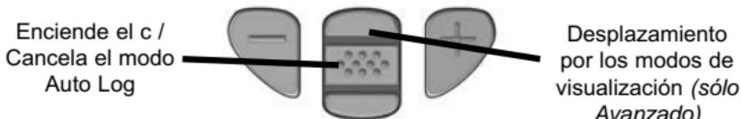
**Los modelos Estándar** quedarán encendidos durante el modo Auto Log. El equipo realizará lecturas durante unas 40-50 horas con pilas alcalinas, dependiendo de la frecuencia de medición.
