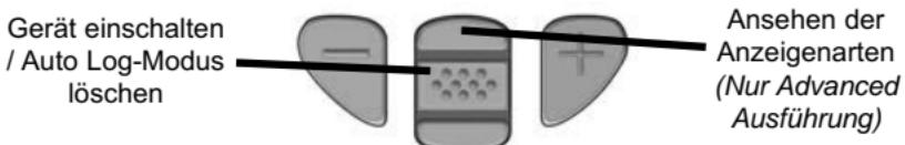
**Standardmodelle** bleiben im Auto Log - Modus eingeschaltet. Mit einem Satz Alkalibatterien nimmt das Gerät 40-50 Stunden lang Messwerte auf, je nach dem wie häufig gemessen wird.
