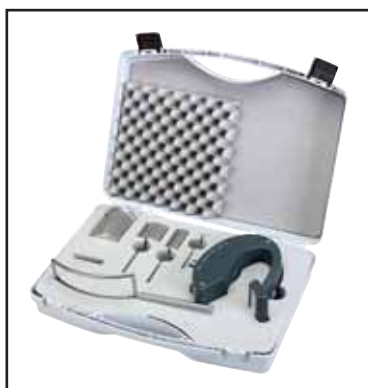
El kit completo incluye rotores, vasos, soporte para laboratorio y estuche.
