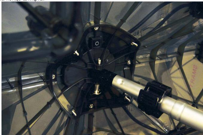
При применении короткого шеста или набора адаптеров SAH22A для брезентовых кожухов необходимо использовать стационарный адаптер шеста, чтобы предотвратить вращение шеста. Поместите стационарный адаптер шеста на прибор SAH22A, закрепив его с помощью предоставленных винтов и крыльчатых гаек. Когда адаптер будет зафиксирован, введите короткий шест и закрепите его с помощью стопорного штифта.
