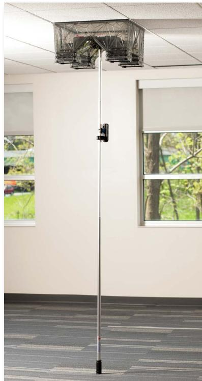
Una vez que la campana esté correctamente colocada, haga girar el poste para ajustar su longitud de modo tal que llegue hasta el piso sosteniendo así la campana. Si la campana no está firmemente ajustada, vuelva a ajustar la longitud del poste.
