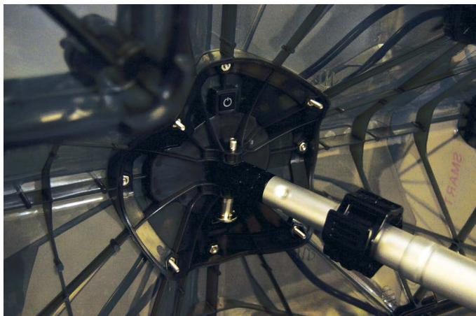
Ao utilizar o poste curto ou com o kit da base adaptadora da SAH22A para capuzes de canvas, o adaptador de poste estacionário deve ser usado para impedir o poste de pivotar. Coloque o adaptador do poste estacionário sobre a SAH22A e prenda-o usando os parafusos e as porcas borboleta fornecidas (abaixo). Quando estiver preso, insira o poste curto e prenda-o no lugar usando a trava de fixação.
