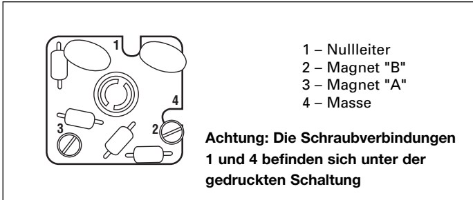
Abbildung 9. DIN-STECKER FUER DEN ELEKTRISCHEN ANSCHLUSS VON VP11, VP21, VP31, VP41 UND VP51
