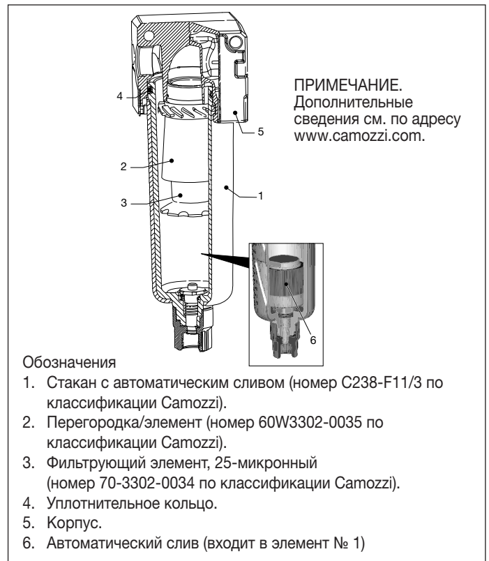
Рисунок 10 – детализация стакана воздушного фильтра
