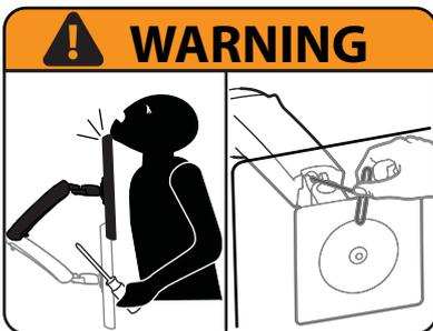
**WARNING!** Gefährdung durch gespeicherte Energie: Der Arm-Mechanismus der Arbeitsfläche steht unter Spannung und bewegt sich von allein und schnell nach oben, sobald das befestigte Gerät abgenommen wird. Entfernen Sie aus diesem Grund die Geräte nur, wenn sich der Arm auf der höchsten Position befindet! Eine Missachtung dieser Anweisung kann zu ernsthaften Verletzungen und/oder Beschädigungen am Gerät führen.
