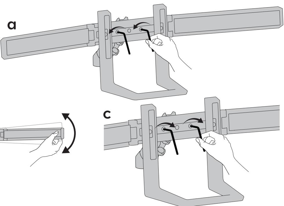
**6** OPTIE: monteer stopschroef om rotatie van de monitor
