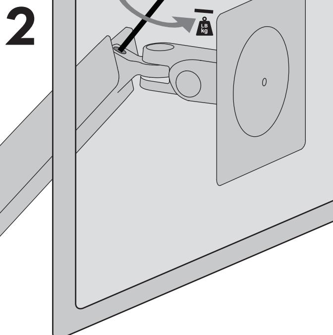
LET OP: draai de schroeven niet te strak aan. Te strak aandraaien kan schade veroorzaken aan uw apparatuur.
