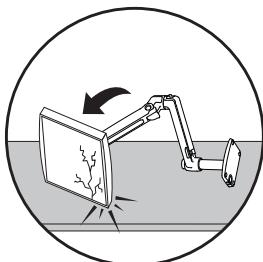
**ADVERTENCIA:** el brazo queda inestable si no se fija con una abrazadera o una montura de ojal. No monte ni utilice el brazo sin fijarlo a una superficie. En caso de no respetar estas instrucciones, podrían producirse daños en el equipo o lesiones físicas. Siga las instrucciones de la abrazadera o montura de ojal para escritorio antes de continuar con estas instrucciones.
