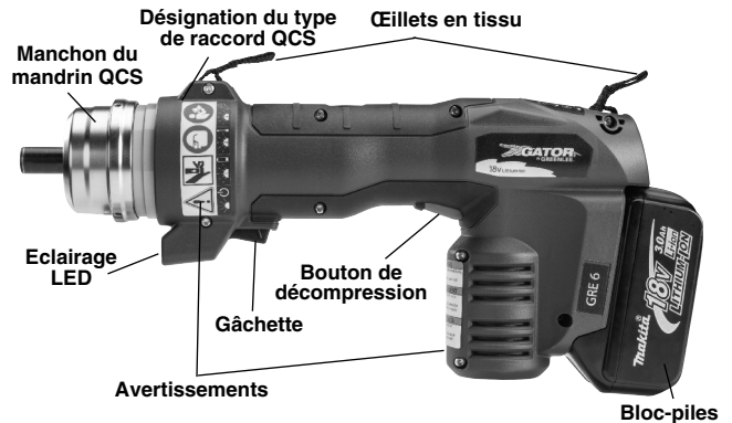
Figure 1 – Pinces électriques types RE 6 et RE 60 avec raccords rapides QCS pour le montage des têtes
