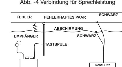
Abb. - 5 Verbindung zur Fehlerlokalisierung von Leiter zu Hülle
