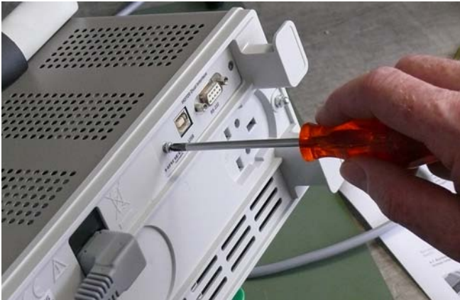
Abb. 2.1: Entfernen Sie die beiden Befestigungsschrauben.
