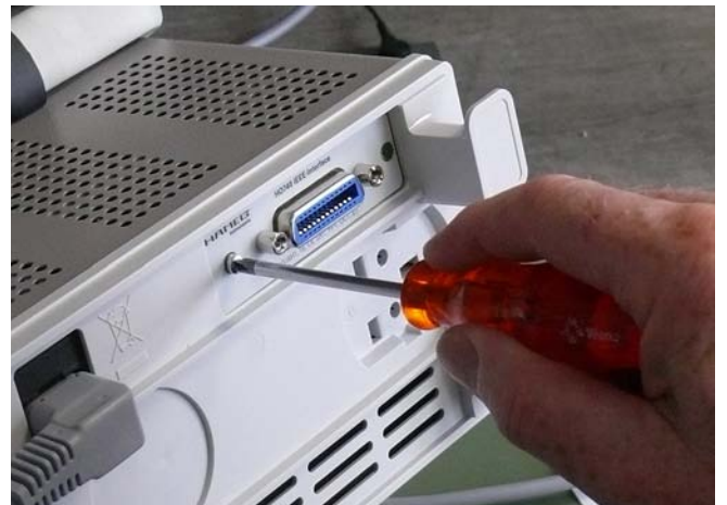
Abb. 2.4: Befestigen Sie die Schnittstelle mit den vorher entfernten (Abb. 2.1) Befestigungsschrauben.
