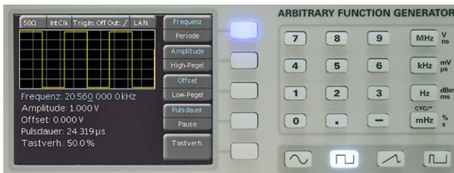
Abb. 4.4: Anzeige für die geänderten Einstellungen
