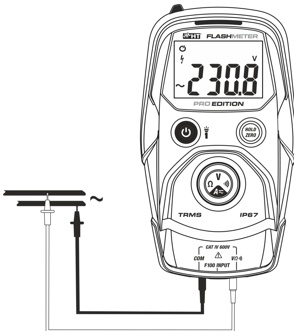
Fig. 4: Uso del instrumento para medida de Tensión CA
