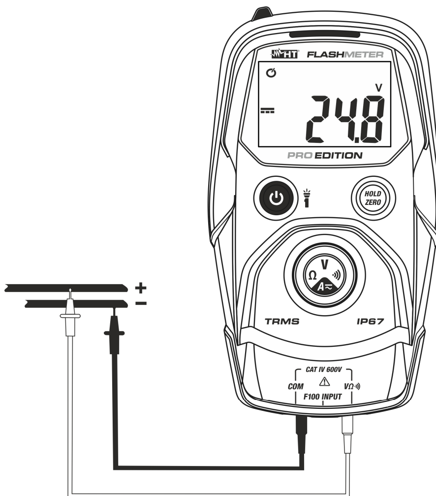
Fig. 3: Utilisation de l'instrument pour la mesure de la Tension CC
