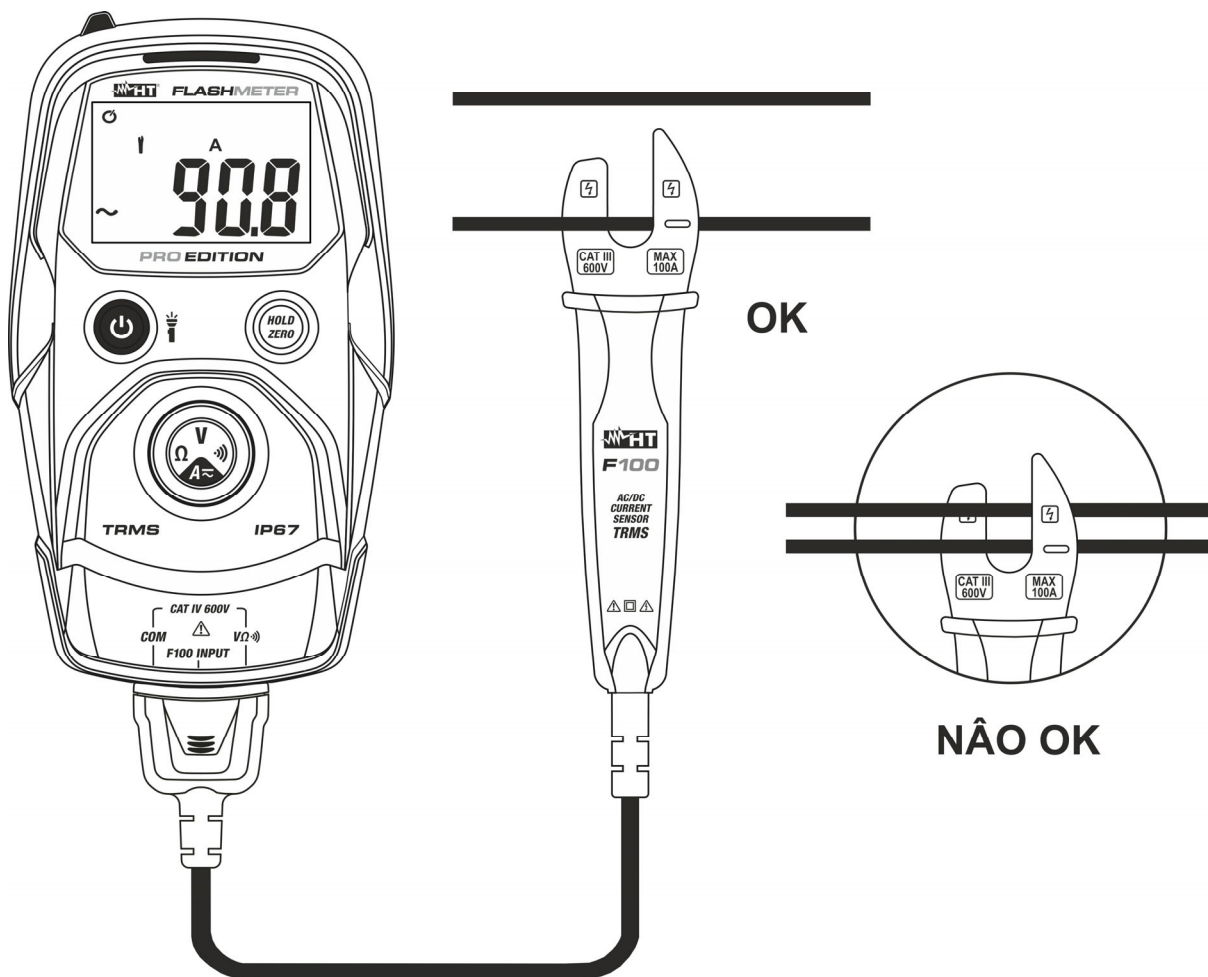
Fig. 7: Uso do instrumento para a medição de Corrente CA/CC
