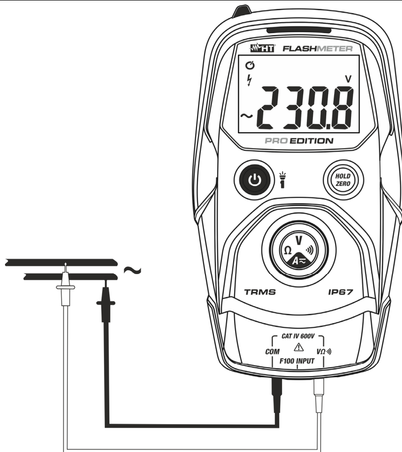
Abb. 4: Verwendung des Gerätes für Wechselspannungsmessung
