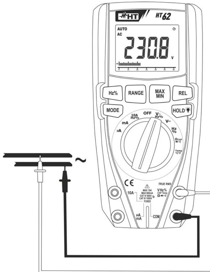
Abb. 3: Verwendung des Gerätes für Wechselspannungsmessung
