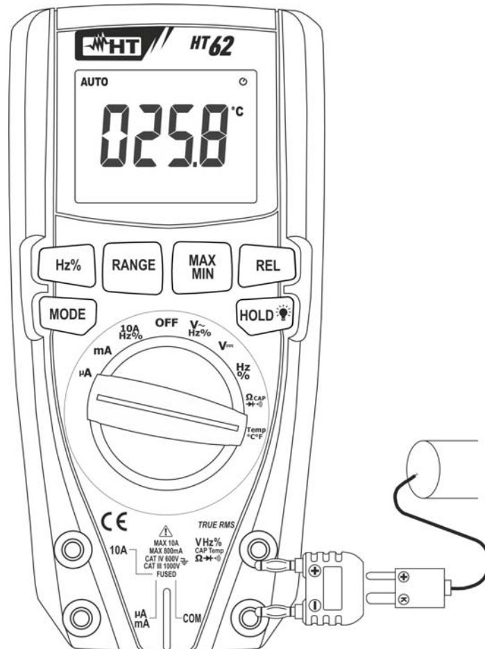
Abb. 8: Verwendung des Gerätes für Temperaturmessung
