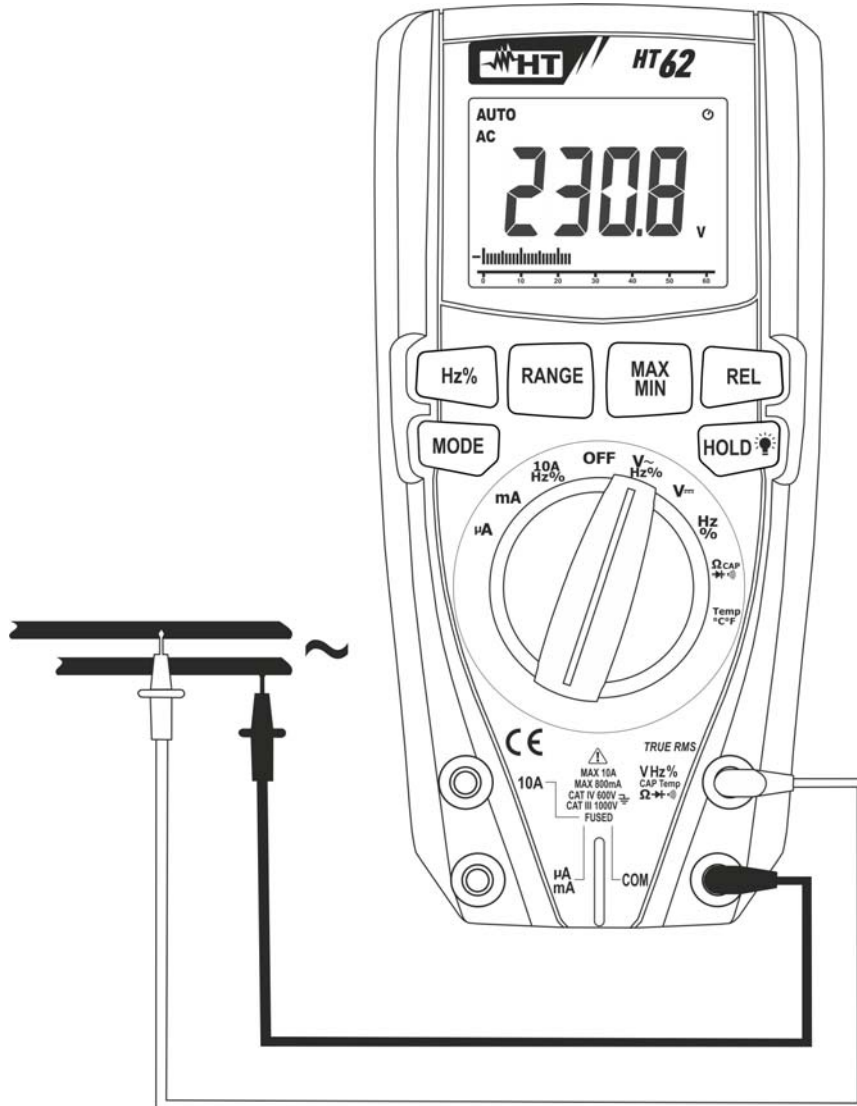
Fig. 3: Mesure de Tension AC
