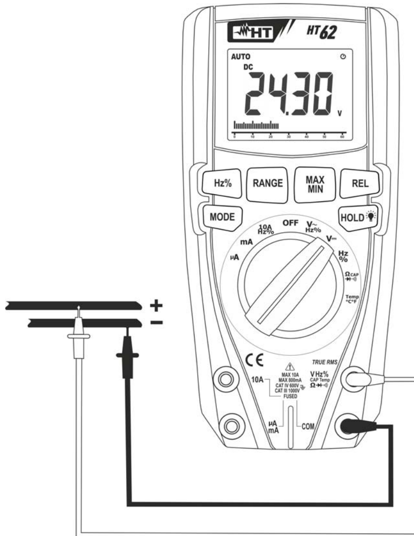
Fig. 2: Mesure de Tension DC
