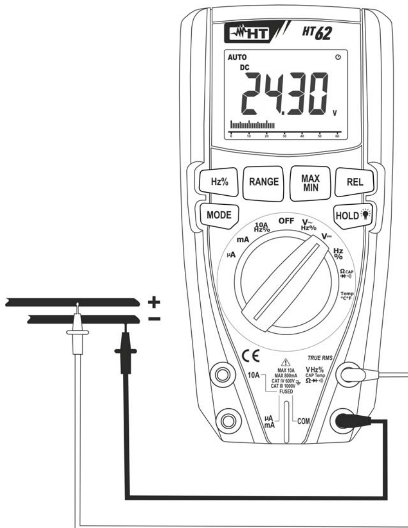
Abb. 2: Verwendung des Gerätes für Gleichspannungsmessung
