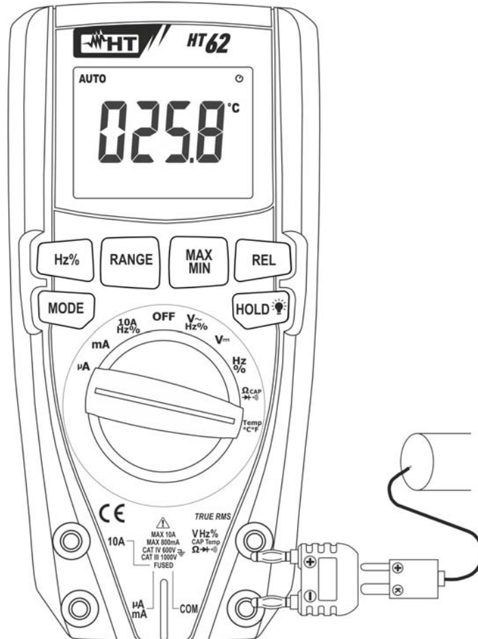
Fig. 8: Mesure de température
