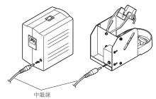
使用省電源機能時,請將中繼線連接到焊鐵座和 焊鐵控制臺背面的插座上。
