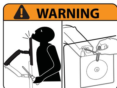
**WARNUNG!** Gefährdung durch gespeicherte Energie: Der Arm-Mechanismus der Arbeitsfläche steht unter Spannung und bewegt sich von allein und schnell nach oben, sobald das befestigte Gerät abgenommen wird. Entfernen Sie aus diesem Grund die Geräte nur, wenn sich der Arm auf der höchsten Position befindet! Eine Missachtung dieser Anweisung kann zu ernsthaften Verletzungen und/oder Beschädigungen am Gerät führen.
