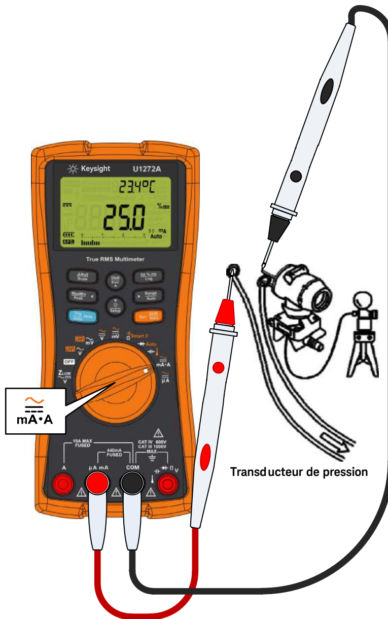
Figure 2-35 Mesure d'un courant CC à l'aide de l'échelle de pourcentage 4-20 mA
