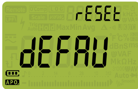
Figure 4-20 Affichage du paramètre rESEt
