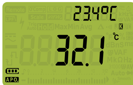
Figura 2-27 Visualizzazione della temperatura
