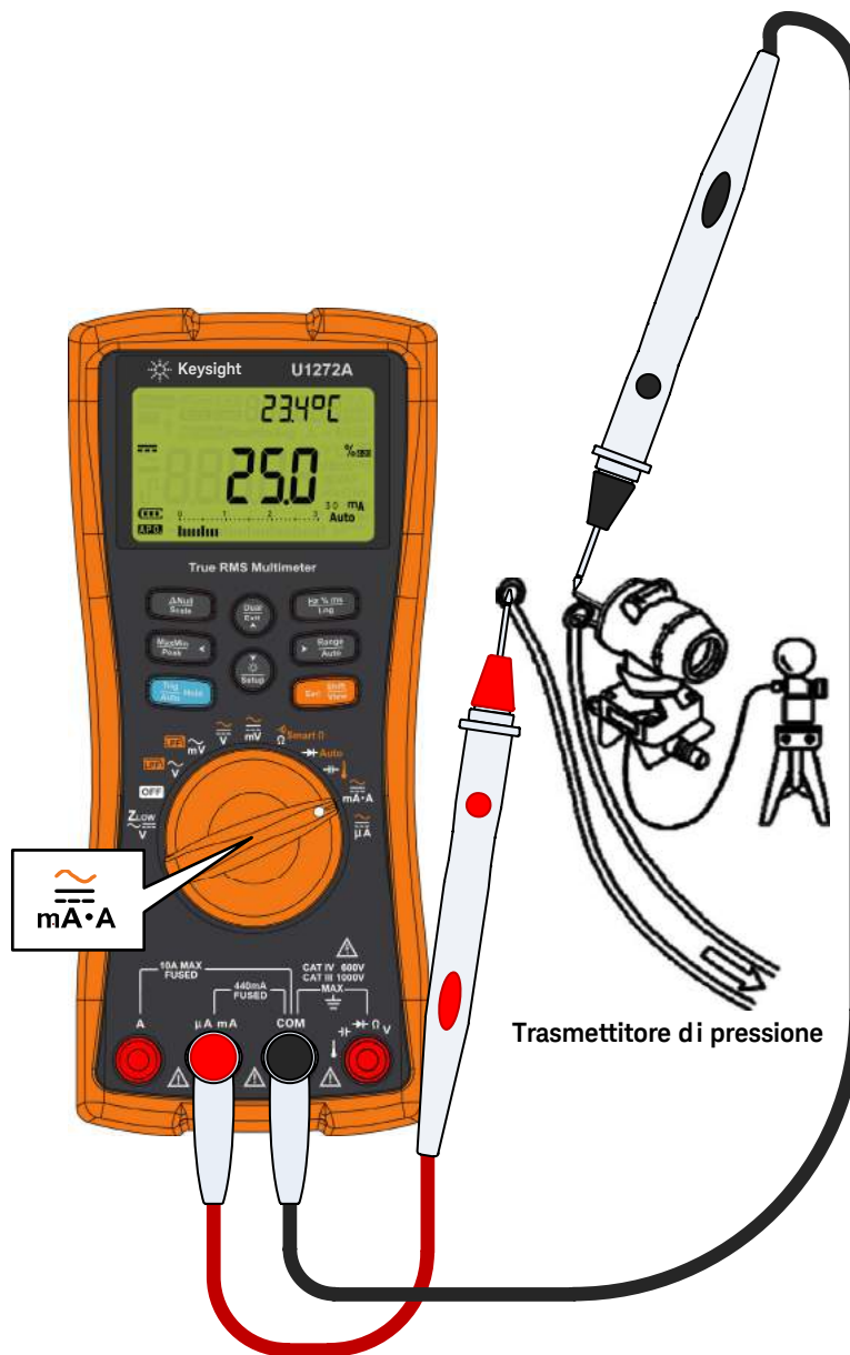
Figura 2-35 Misurazione della corrente CC utilizzando la scala % di 4-20 mA
