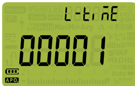
Figure 4-5 Affichage du paramètre L-tiME
