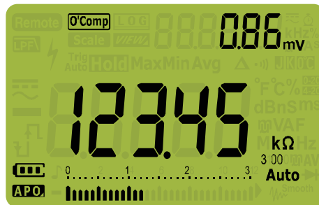
Figura 2-17 Visualizzazione Smart \Omega (con tensione di polarizzazione)
