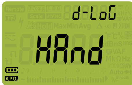
Figure 4-4 Affichage du paramètre d-LoG
