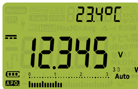
Figura 2-4 Visualizzazione della tensione CC
