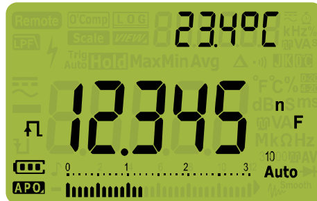
Figura 2-25 Visualizzazione della capacitanza
