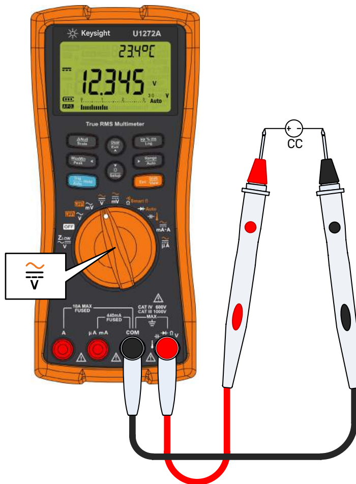
Figura 2-5 Misurazione della tensione cc
