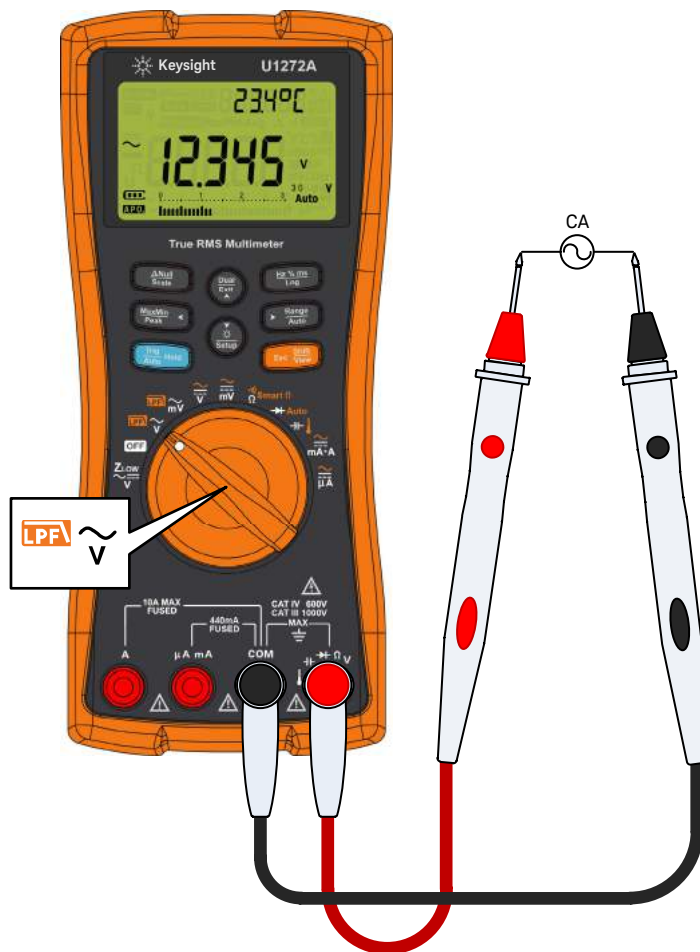
Figura 2-2 Medición de tensión de CA
