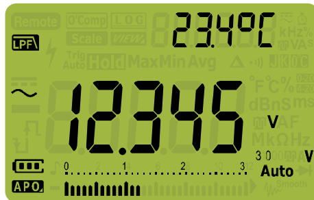
Figura 2-3 Tensión de CA con visualización de LPF
