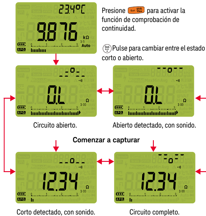
Figura 2-15 Operación de continuidad
