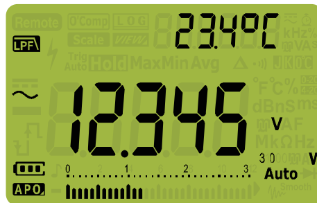
Figura 2-3 Tensione CA con visualizzazione LPF
