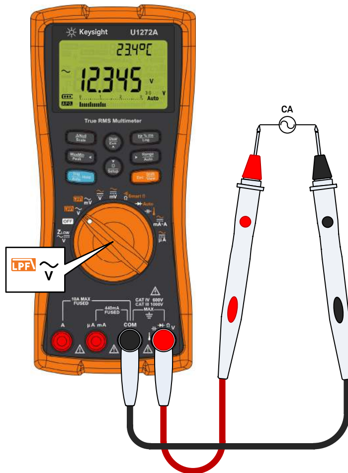
Figure 2-2 Mesure de tension CA
