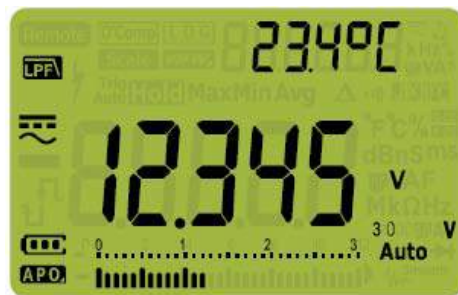
Figure 2-8 Filtre passe-bas (LPF) pour les mesures de tension CA+CC
