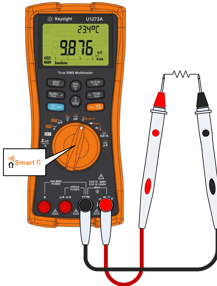
Figura 2-14 Medición de resistencia
