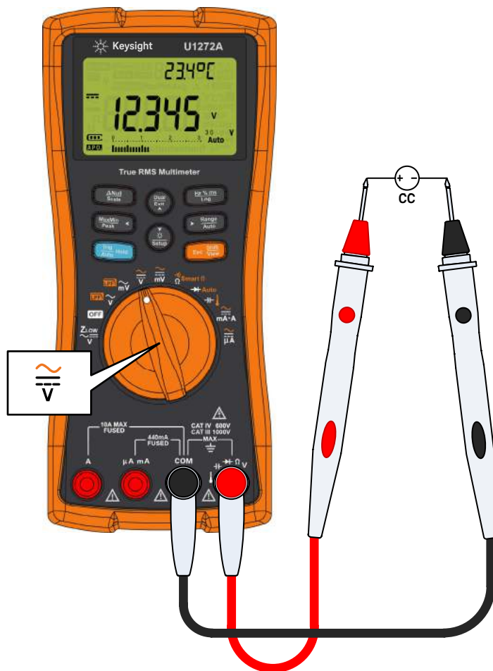
Figura 2-5 Medición de tensión de CC
