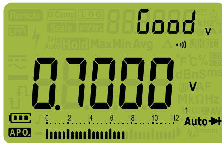
Figure 2-23 Affichage de la fonction diode automatique - État Good
