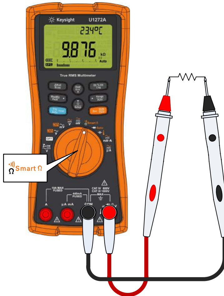
Figure 2-14 Mesure de la résistance
