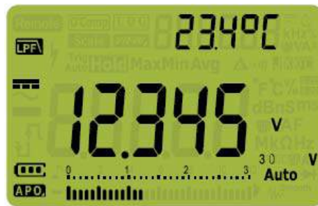
Figura 2-6 Filtro para mediciones de voltaje de CC
