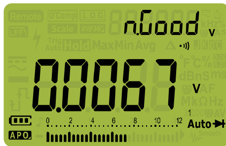
Figura 2-24 Visualizzazione Auto-diode - stato nGood (non funzionante)
