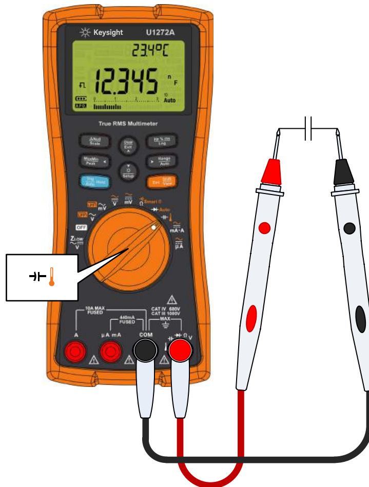
Figure 2-26 Mesure de capacité
