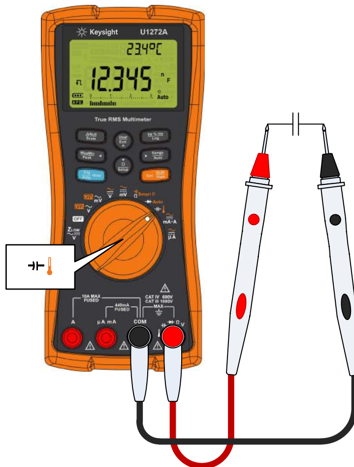
Figura 2-26 Misurazione della capacit anza
