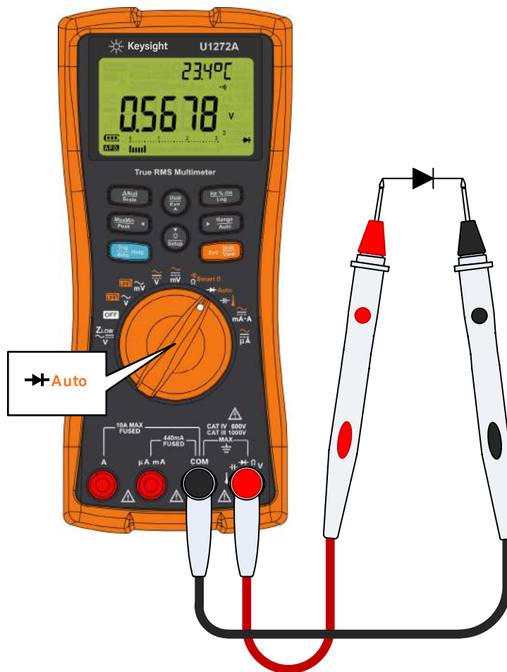
Figura 2-21 Prueba de diodo de polarización directa
