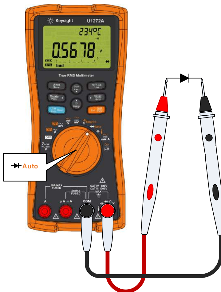
Figura 2-21 Test di diodi con polarizzazione diretta
