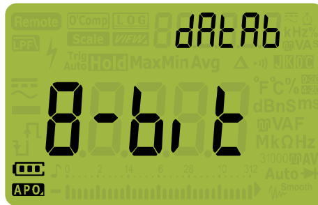
Figure 4-15 Affichage du paramètre dAtAb
