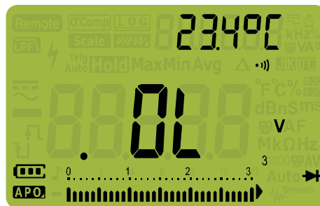
Figura 2-20 Visualizzazione di un diodo aperto
