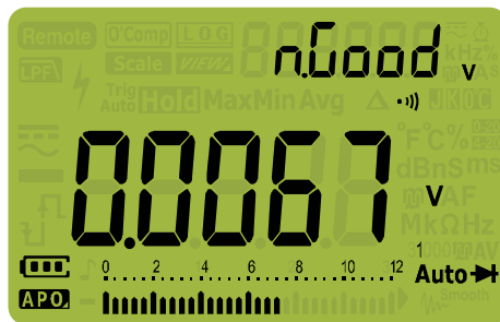
Figura 2-24 Visualización de autocomprobación de diodo - Estado: nGood (No muy bien)
