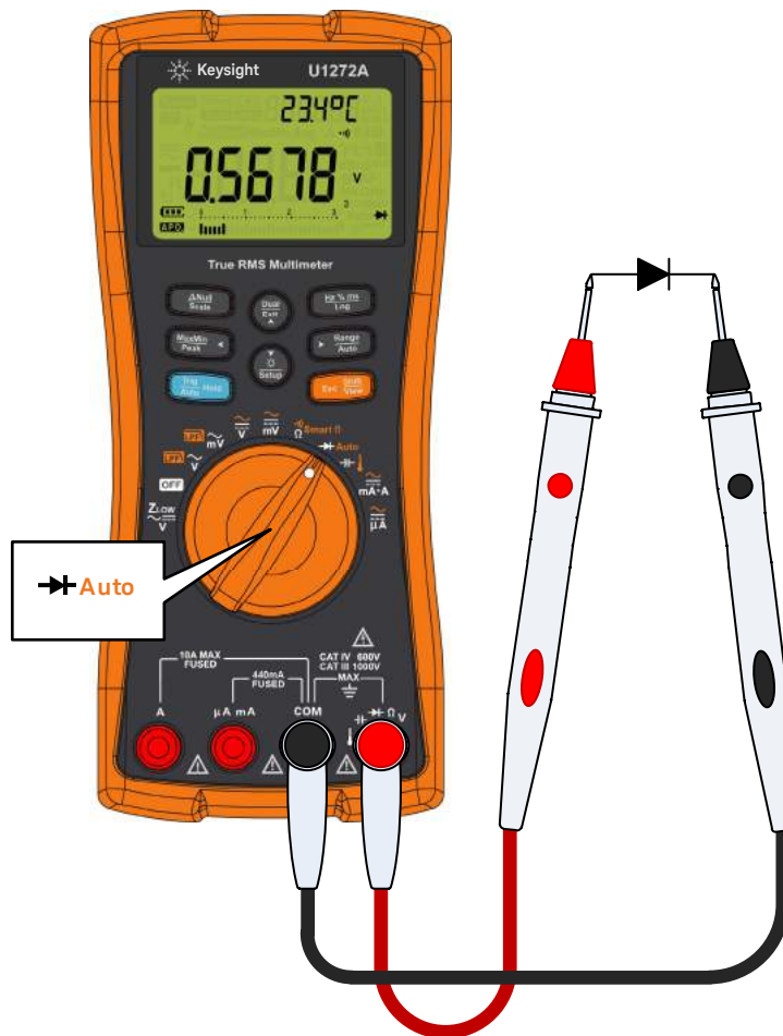
Figure 2-21 Test de polarisation directe de la diode
