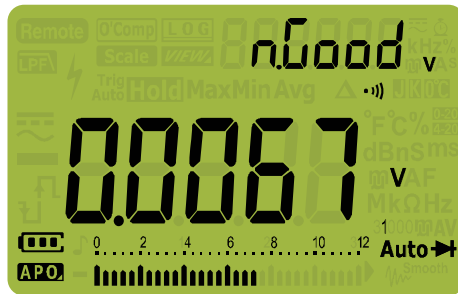
Figure 2-24 Affichage de la fonction diode automatique - État nGood
