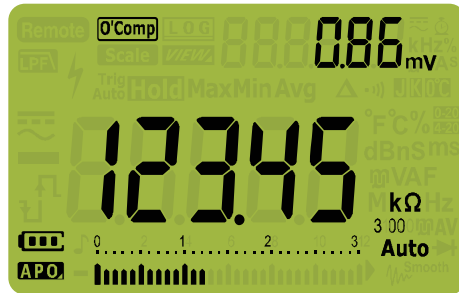
Figura 2-17 Visualización de Smart \Omega (con tensión de polarización)
