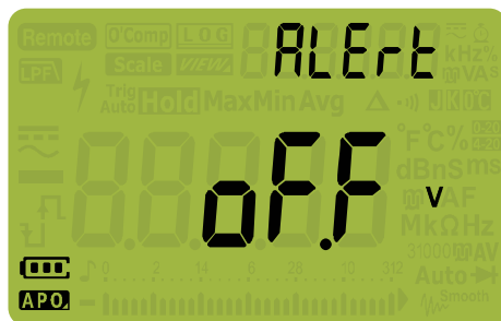
Figure 4-10 Affichage du paramètre ALERt
