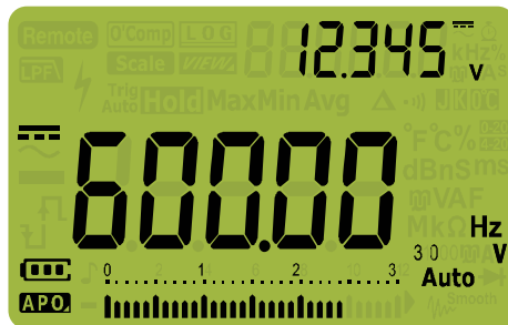
Figura 2-38 Visualización de frecuencia
