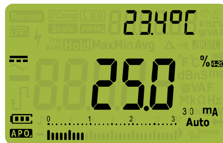
Figura 2-34 Visualizzazione della scala % 4-20 mA
