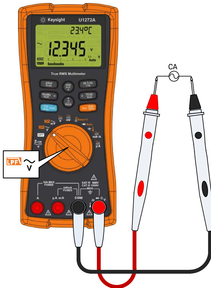
Figura 2-2 Misurazione della tensione CA
