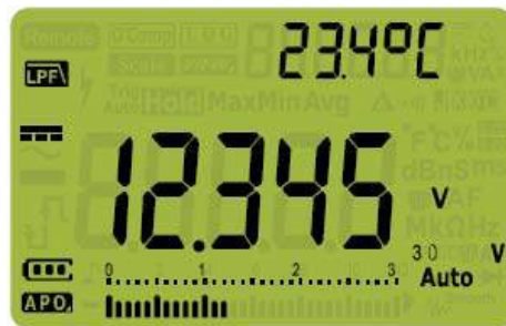
Figura 2-6 Filtro per le misurazioni di tensioni CC
