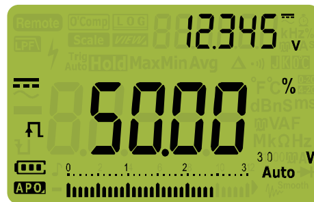
Figura 2-40 Visualizzazione del duty cycle
