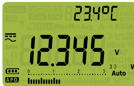
Figura 2-7 Visualizzazione della tensione CA+CC
