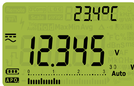
Figura 2-7 Visualización de la tensión de CA+CC
