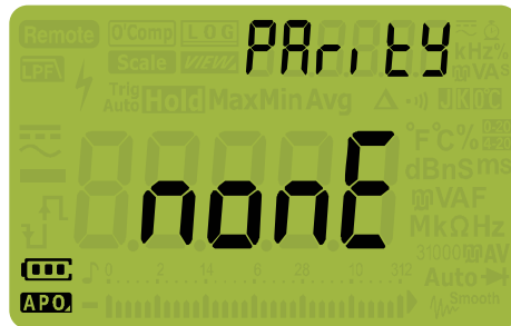
Figura 4-16 Visualización de PARitY
