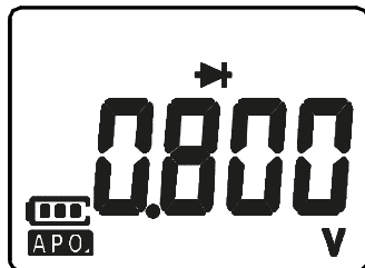
Figura 2-13 Valore diodo sul display
