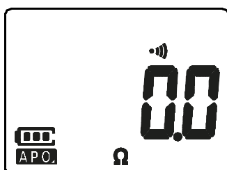
Figura 2-11 Valore continuità circuito chiuso sul display
