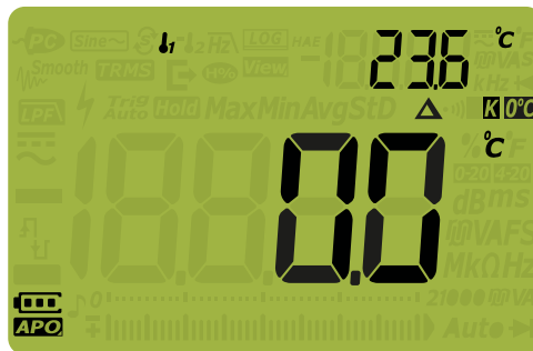
Figura 2-22 Medición de temperatura sin compensación ambiental
