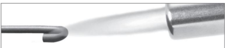
**SP** 3. Caliente la cinta hasta un rojo mate y doble completamente la punta utilizando unos alicates de 3/16 de pulgada. Deje que la cinta se enfrie completamente.
