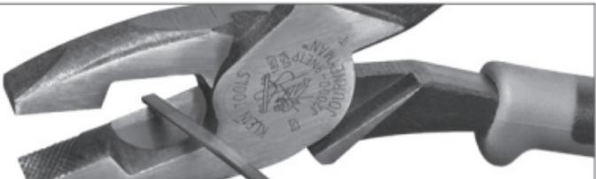
**SP** 1. Haga un corte limpio de cinta de acero de 1/8 de pulgada donde se vaya a sujetar la guía.
