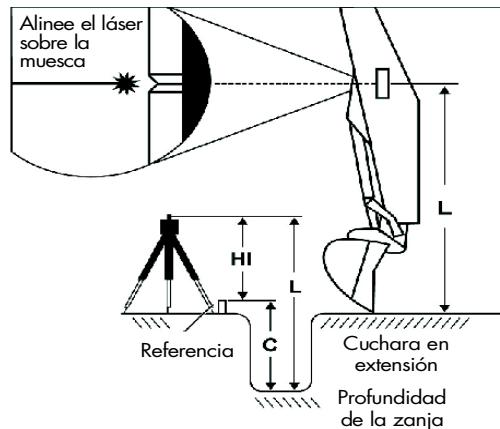
Para calcular la altura de instalación, mida primero la altura del instrumento ( $HI$ ) y añada la profundidad de la zanja ( $C$ ) para calcular la profundidad total ( $L = C + HI$ ).
