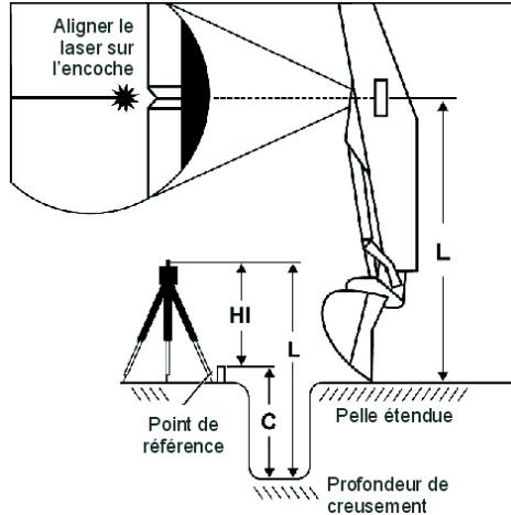
Pour calculer la hauteur d'installation, mesurer d'abord la hauteur de l'instrument (HI) ; y ajouter la profondeur de la tranchée (C) pour en déduire la profondeur totale ( $L = C + HI$ ).
