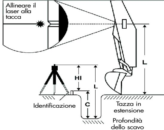
Per calcolare l'altezza d'installazione, misurare innanzitutto l'altezza dello strumento (HI); aggiungere la profondità dello scavo (C) per ricavare la profondità totale ( $L = C + HI$ ).
