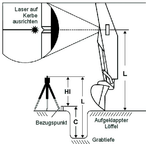
Bauen Sie den Laser an einem Punkt auf, wo der Empfänger problemlos den Strahl empfangen kann und schalten sie ihn ein.
