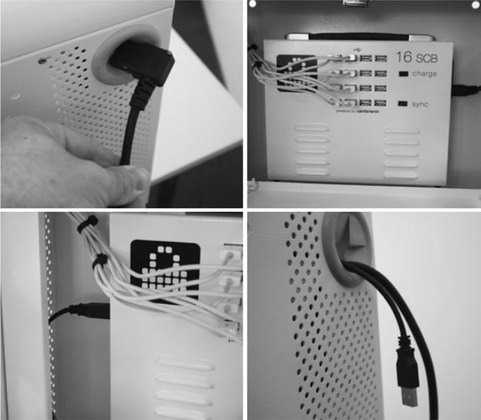
**PASO 4. Tienda 8 cables USB desde la iQ Wall Cage izquierda hasta la iQ 16 SCB.**
