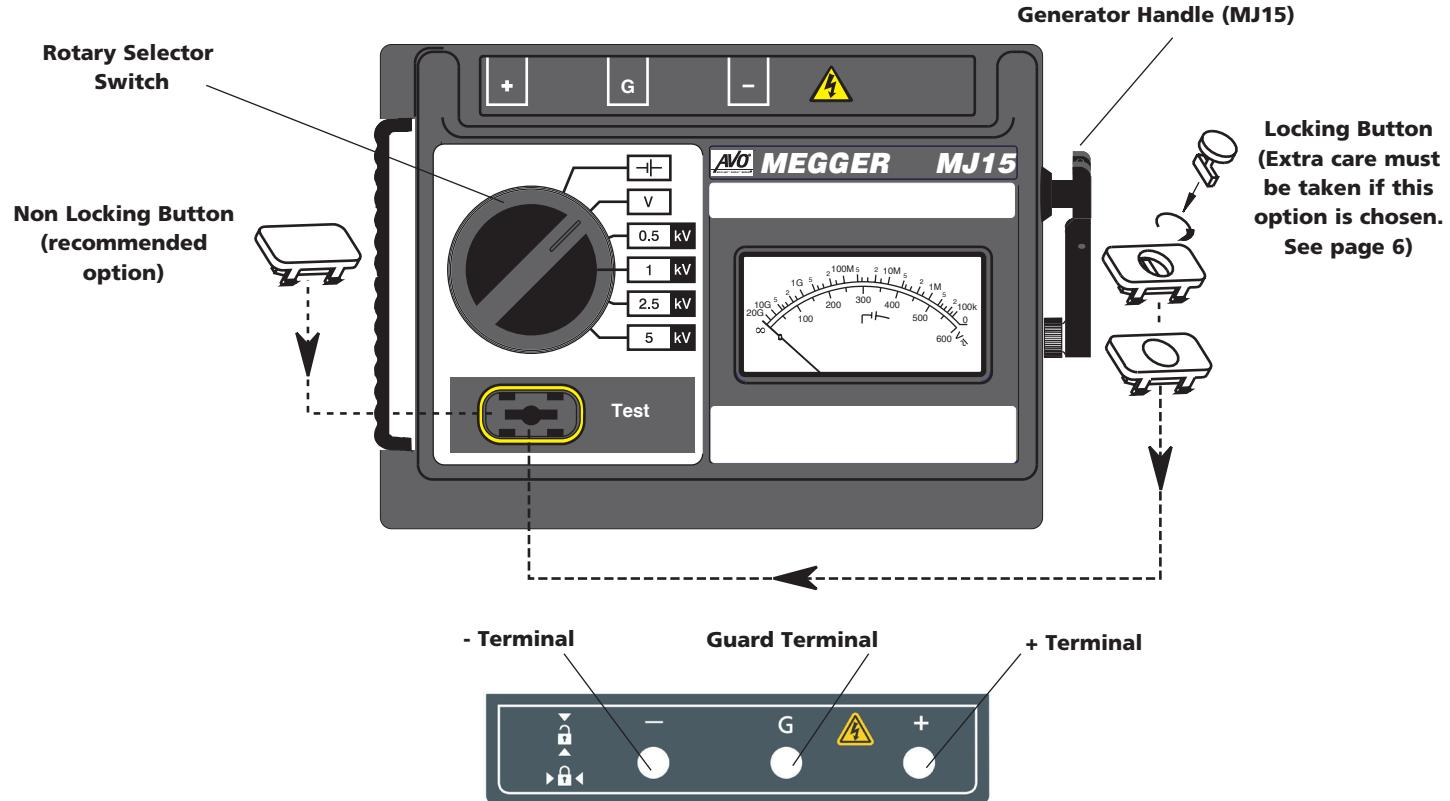
**TO INSERT TERMINAL PLUGS, PUSH IN - TO RELEASE, TWIST A QUARTER TURN AND PULL OUT**
