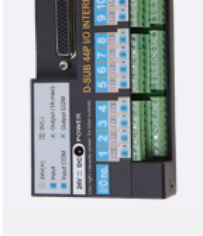
I/O Wiring Box
