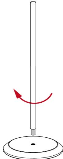
2. Maintenez le bouton situé au bas du bras d'électrode supérieur et passez le bras à travers le bâton métallique.
