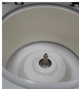
Eje del motor y cámara
