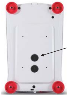
Schutzabdeckung des Unterflurwägehakens wiegen
