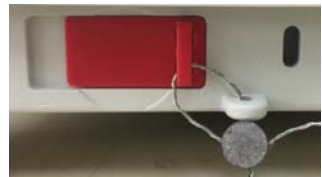
Bloqueado con cable de sellado
