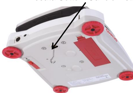
Pesata Sotto il Gancio installato
