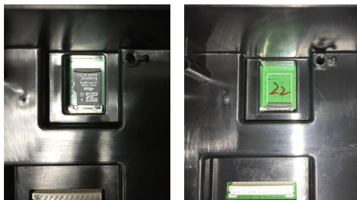
Abbildung 2-5 Einschoben einer SD-Karte in die SD-Buchse (links); SD-Karte installiert (rechts)
