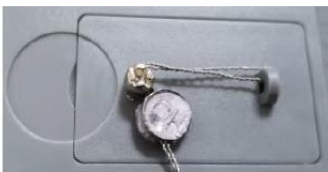
Sellado mediante cable
