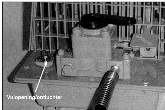
Afbeelding 2 - Locatie van de ontluichtings-/vuldop
