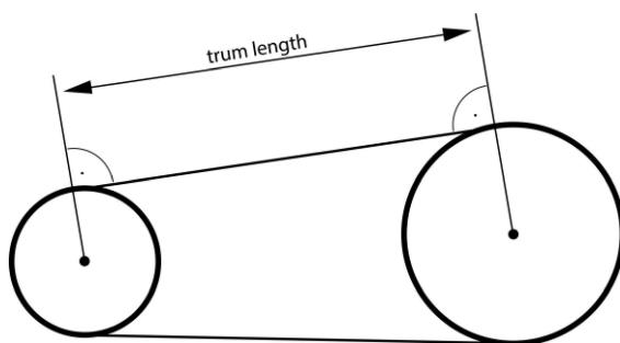
In der Regel kann die Trumlänge direkt am Riemen gemessen werden. Messen Sie die oben beschriebene Länge (trum length) und geben diese im Menü „Kraft“ für die Länge ein. Manchmal ist es nicht möglich, diese Länge zu messen - dann können Sie die Länge mit folgender Formel ermitteln:
