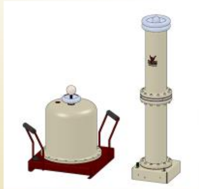
HV Transformer + Rectifier / Divider Assembly
