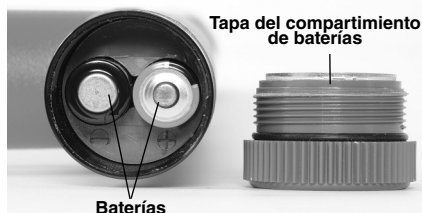
Figura 7 – Reemplazo de las baterías (receptor)
