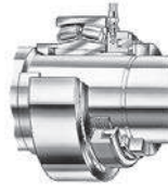
Bild 8. Ausbau eines Lager auf Spannhülse mit einer auf dem Hülsengewinde montierten Hydraulikmutter, die gegen einen Anschlag auf der Welle abgestützt ist.
