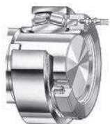
Figure 7. HMV non utilisé pour retirer un manchon de démontage
