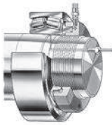
Bild 3. Einbau eines Lagers direkt auf kegeligem Sitz
