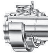
Figure 8. Écrou HMV et bague de butée en position pour démonter un manchon de serrage
