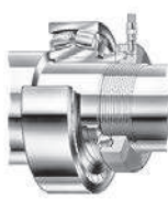
Figura 5. Porca HMV apertada no eixo para colocação numa manga de ressalto
