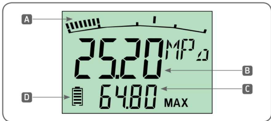
De display-modus geeft de actuele druk. De gemeten waarden wordt in de betreffende eenheid weergegeven. De waarde voor MAX of FS staat in het onderste deel van de display.
